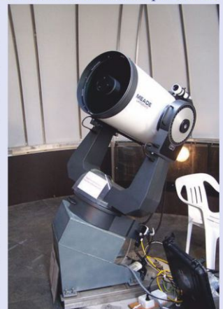
Telescopio amatoriale Schmidt-Cassegrain su montatura a forcella con base equatoriale
